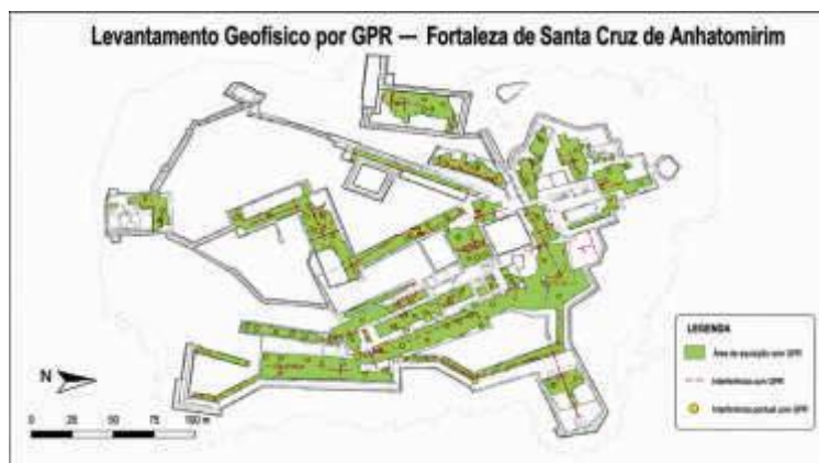
Figura 1 – Resultado do levantamento geofísico por Ground Penetrating Radar (GPR) realizado em área de intervenção da Fortaleza de Santa Cruz de Anhatomirim.
