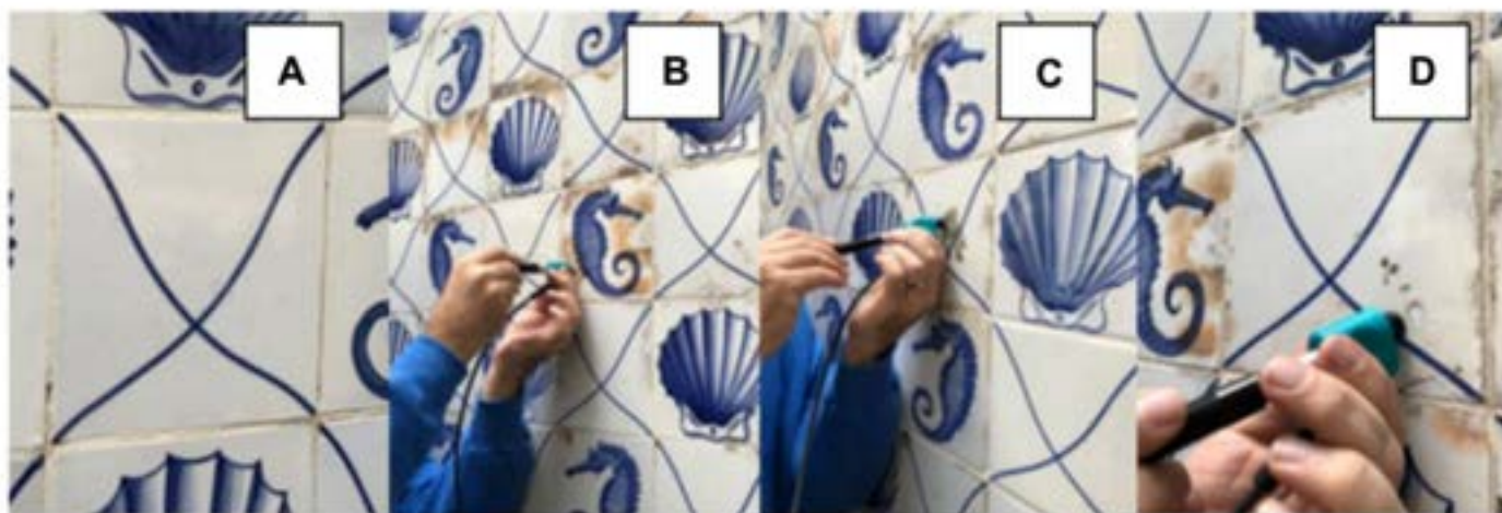
Figura 2: (A): Azulejo íntegro; (B) fungo rosa; (C) fungo negro e (D) azulejo perfurado.
