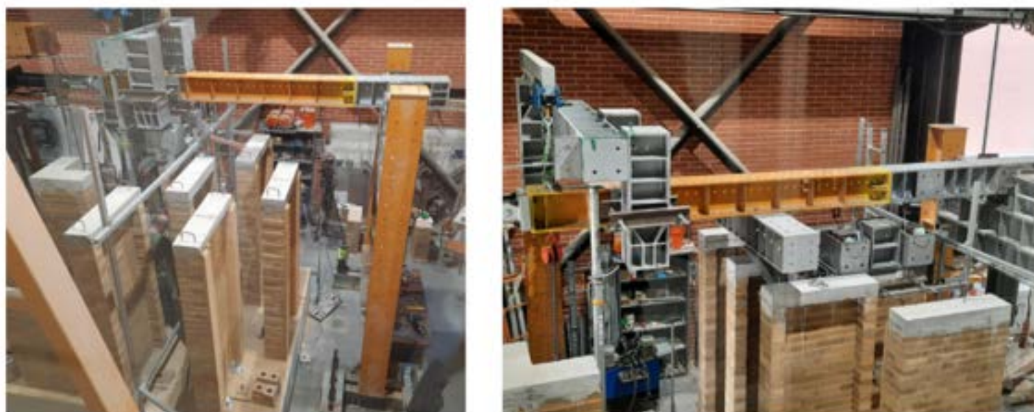
Figura 2: Paineis em escala real para ensaio cíclico de corte com flexão fora do plano (esquerda) e no plano (direita).
