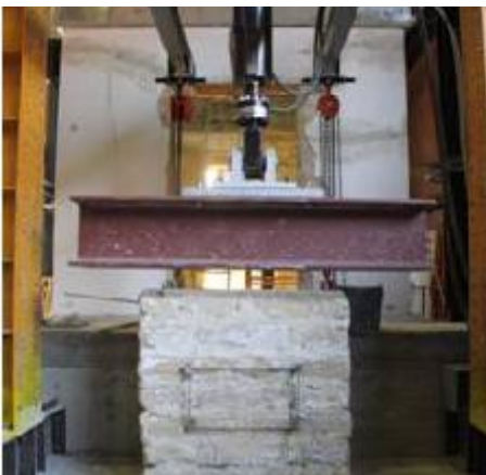
À direita Figuras 10 e 11 – Setup de ensaio para determinação da resistência à compressão: pórtico de ensaio e setup de instrumentação. Fonte: Foto e desenho dos autores.
