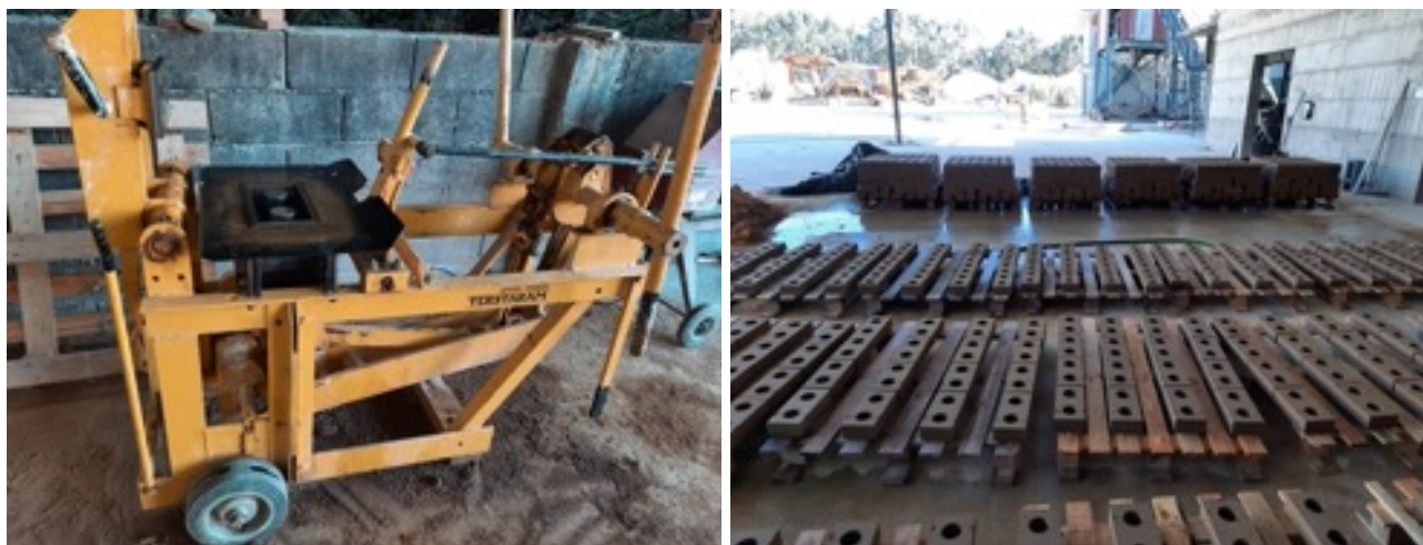
Figura 2: Prensa manual mecânica usada na produção dos tijolos (esquerda) e área da fábrica montada no estaleiro da empresa Vagoinertes LDA. (direita).
