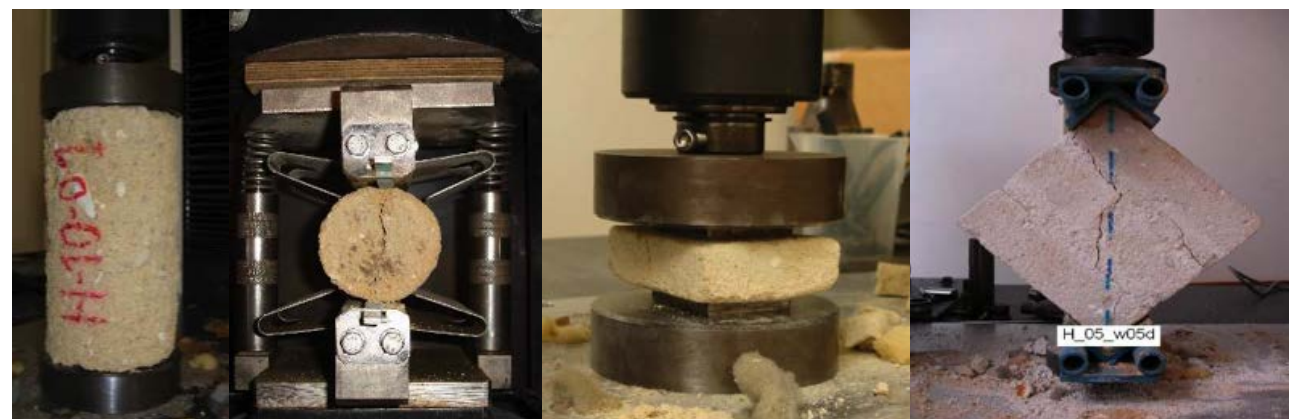
Figura 4 Ensaio à compressão
