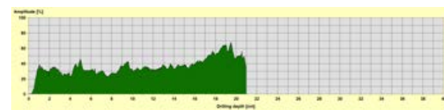
Figura 22 – Exemplo de registo de avaliação da estrutura de madeira com Resistograph
