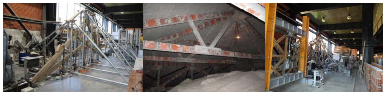
Figura 12 – Ensaio de asnas de madeira
