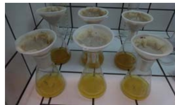
Figura 23 – Ensaios laboratoriais para determinação de rácio agregado/ligante
