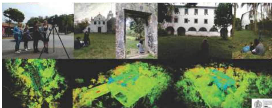
Figura 6: Levantamento digital com laser scanner 3D, acompanhado com desenhos de observação, fotografias, para depois ser realizado os desenhos técnicos em programa de computador (AutoCAD) a partir da ortoimagem gerada pela nuvem de pontos, adotando a metodologia do Laboratorio Rilievo dell'Architettura (LRA) da Università degli Studi di Firenze. Nas imagens aparecem as arquitetas: Anastasia Cottini, Chiara Alessi, Emanuelle Cristina Cordeiro, Fernanda Gianotti Fernandes, Maria Beatriz Gabara Rodriguez, Pietro Becherini e Regina Helena Vieira Santos, fotos 2017/18.
