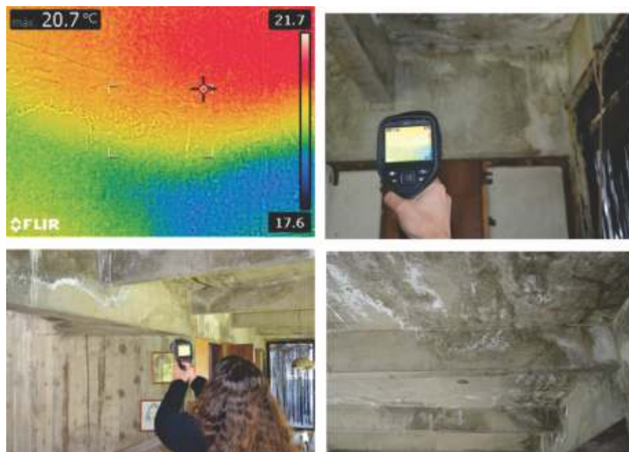
Figura 7: Realização de ENDs utilizando a termo câmera e pacômetro digital Fonte: Fotomontagem da autora, 2026.
