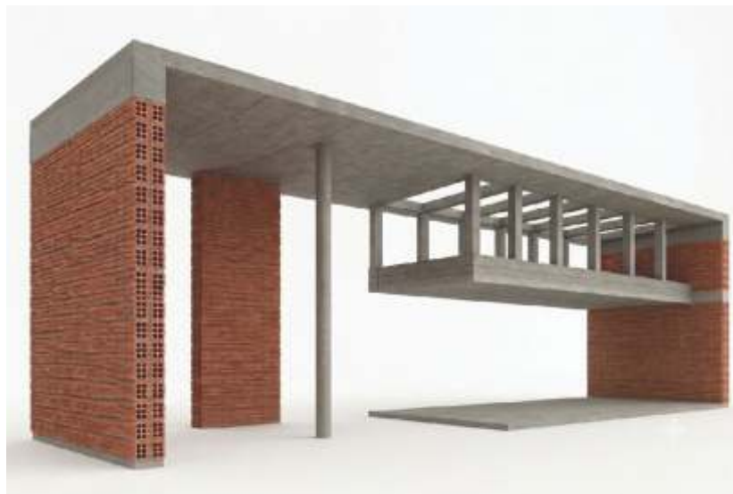
Imagem3 - Simulação do possível arranjo da estrutura original auxiliado por HBIM. Fonte: Departamento de Patrimônio Histórico, Casa de Oswaldo Cruz, 2025.
